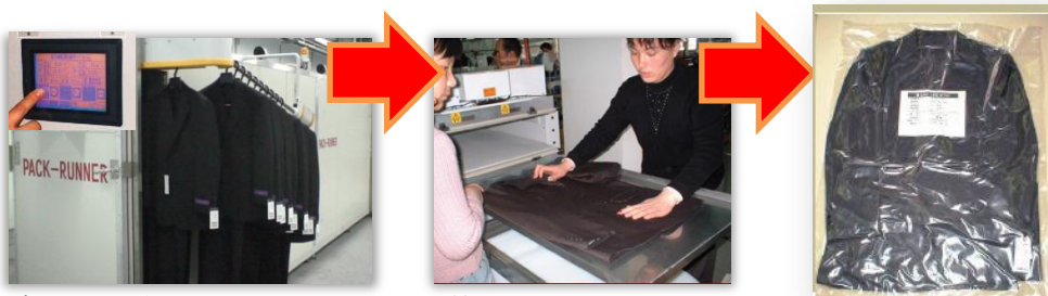
デジタル設定による乾燥熱処理 → 圧縮パック+ヒートシール
