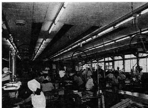
図-38 懸垂型加湿装で、加湿中の縫製工場
