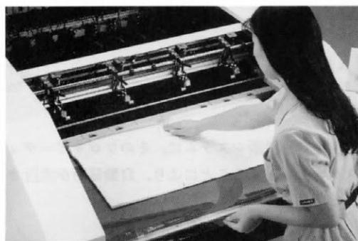
① 粗裁ちされたロットを機械前面の生地セットテーブルに載せる
