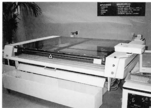
図-5 レーザー方式高速裁断
