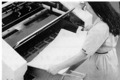
④ 生地セットテーブルの手前の部分を開いて柄合わせしたロットを生地セットプレート後取り出す。
